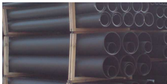
Palety s rúrami skladovaných nad sebou
