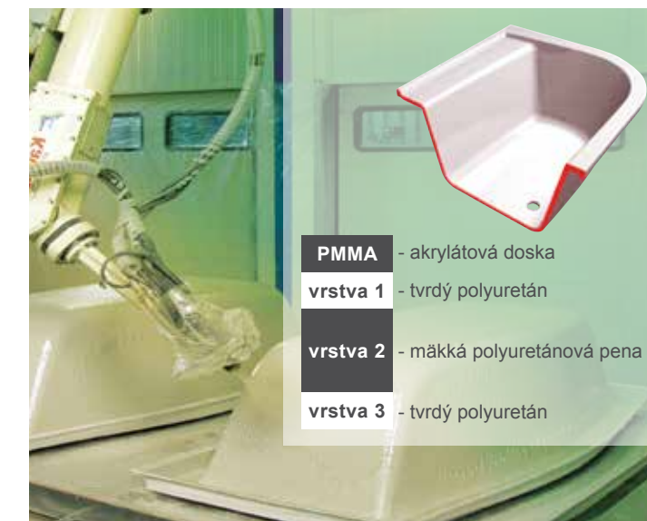
Unikátna technológia vyztuženia polyuretánovou penou vyvinutá firmou RAVAK. Trojnásobný nástrek polyuretánu dodáva vaniam PU Plus jedinečnú pevnosť a vynikajúce tepelné i zvukové izolačné vlastnosti. Tieto vane sú vhodné najmä na montáž hydromasážnych systémov a sú aj ekologicky recyklovateľné.
