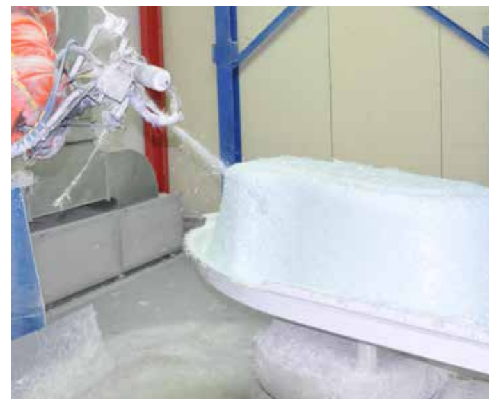
Pri vyztužení laminátom dochádza k nástreku zmesi živice a skleneného vlákna na akrylátový výlisk. Pomer týchto zložiek a množstvo nástreku je riadený počítačom individuálne pre každú vaňu. Výhodou laminátu je vysoká pevnosť a tuhosť výrobku, ktorý je dostupný za priaznivú cenu.
