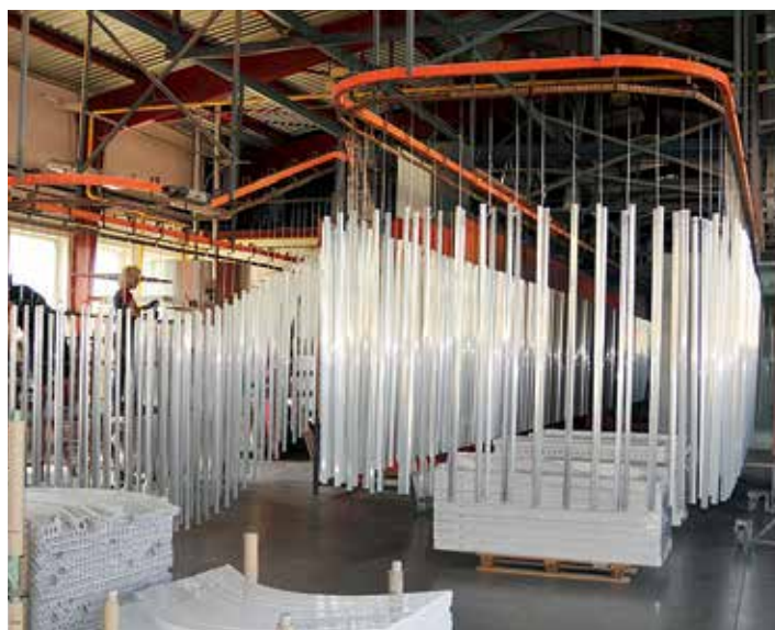
Elektrostatické nanášanie práškovej farby na hliníkové profily sprchových kútov, dverí a vaňových zásten.
