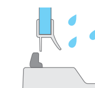
Bezrámové kúty RAVAK sú vybavené 18 mm vysokou prahovou lištou a spodnou okapničkou, ktoré poskytnú dostatočnú mieru utesnenia
