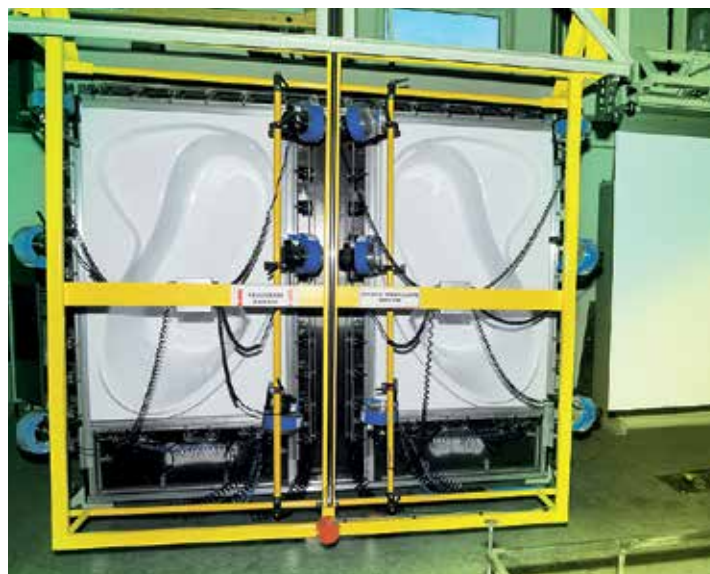
Lisovanie akrylátového výlisku budúcej vane pomocou najnovšej technológie využívajúcej zvislý ohrev.
