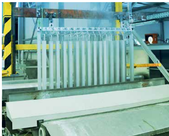
Eloxovanie hliníkových profilov - výroba najtvrdšej povrchovej úpravy sprchových kútov, dverí a vaňových zásten - satin.
