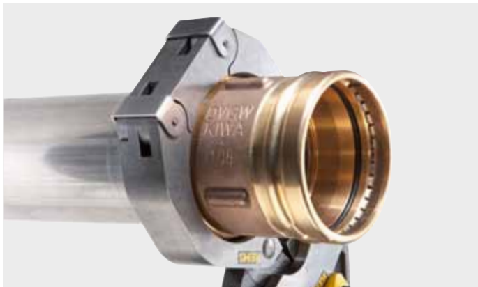
REMS lisovací kroužek (PR-3B) s 3-mi lisovacími čelistmi pro náročná lisování velkých rozměrů. Optimální lisování díky radiálně řízenému pohybu lisovacích čelistí, s mezikleštěmi.
