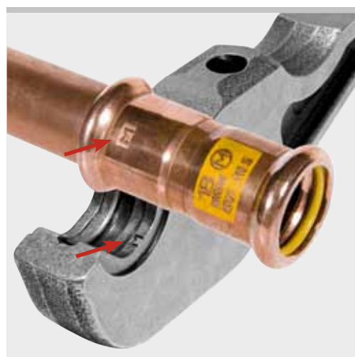
Příklad lisovacích kleští REMS M: Otisk "M" na zalisované tvarovce pro zpětné dosledování dle EN 1775:2007
