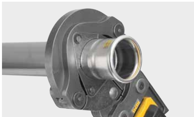
Lisovací kroužek (PR-3S) REMS s 3-mi na kloubovém kroužku vedenými výklopnými lisovacími segmenty pro lisování velkých dimenzí s vysokými požadavky. Optimální lisování díky radiálně řízenému pohybu lisovacích segmentů, s mezikleštěmi.
