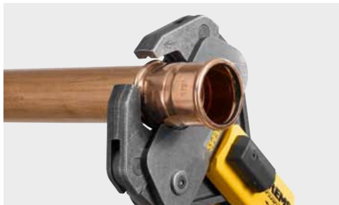
REMS lisovací kleště (4G) se 2 kloubově výklopnými, paralelně vedenými lisovacími segmenty pro přímočaré lisování středně velkých dimenzí.
