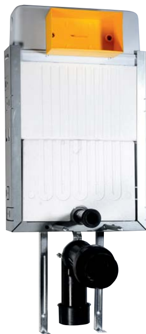
5413-02 Podomietková nádržka pre zamurovanie (bez tlačítka), hĺbka 120 mm, šírka 420 mm
