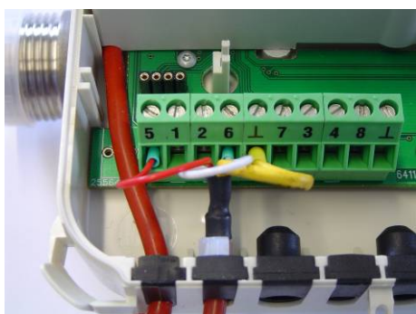
Obr. 6: Dvojvodičové pripojenie s tieniacim káblom
