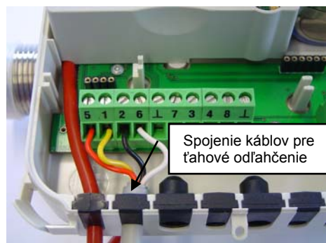
Obr. 8: Príklad štvorvodičového pripojenia
