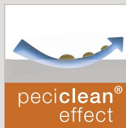
Povrch škáry je superhydrofilný, t.j. priľahuje vodu. Všetka voda, ktorá príde do kontaktu s povrchom, vytvára na ňom tenký vodný film. Prebytočná voda podmýva nečistotu, čím je možné ju ľahšie odstrániť. Všetky nečistoty, ktoré sa dostanú na povrch sú vytlačené vodným filmom. Rozpusťné látky sa rozpustia a vyplavia. Vďaka peciclean® efektu, zostáva škára hygienická a čistá počas dlhej doby.
