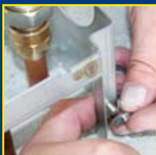
8. Šrouby pro upevnění hliníkového krytu
