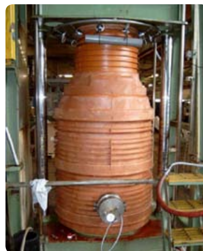
zkouška zatěžováním a zkouška vodotěsnosti
