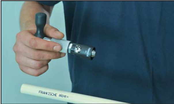
Vloženie odhrotovača priemeru 20 mm do univerzálneho držiaka pre priemery 16 - 32 mm.
