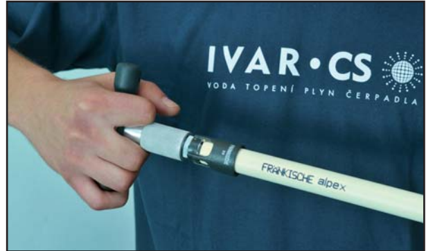
Odhrotovanie a úprava čela rúrky - otáčaním v smere hodinových ručičiek.
