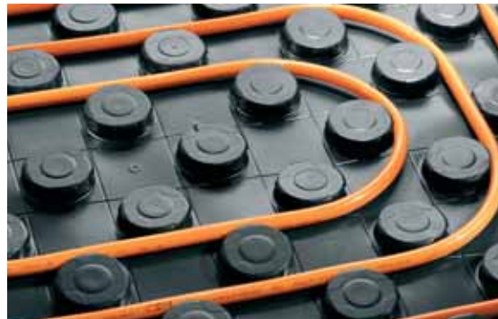
5a. Minimálny polomer oblúka rúrok sa dosiahne ohybom okolo 3 výstupkov pri ohybe o 180°, príp. okolo 2 výstupkov pri ohybe o 90°
