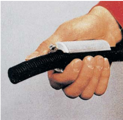
4. Nasleduje montáž rúrky na vykurovacie teleso. Na skrátenie ochrannej rúrky jediným bezpečným a spoľahlivým spôsobom slúži orezávač GT-AGS.
