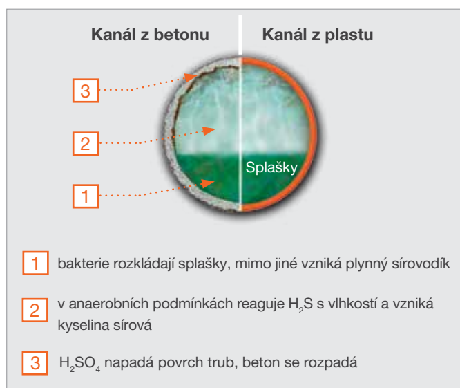
Porovnání chemické koroze
