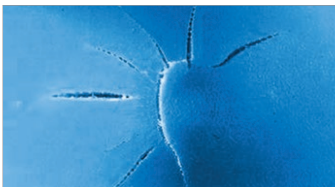
Poškození dlouhodobým působením napětí
