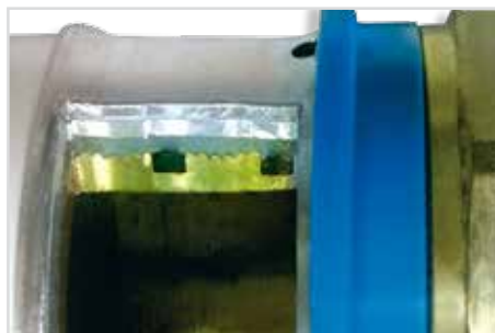
Řez lisovaným spojem
