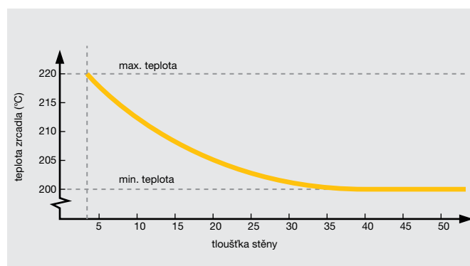
Nastavení teploty zrcadla dle tloušťky stěny
