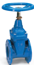
Séria 06 Posúvač s ukazovateľom polohy DN 50-300 PN 10 alebo 16 GJS-500-7
