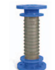
Séria 78/8210 Spájacie puzdro s prírubou z miešanej tavennej ocele pre steny prechodovej nádrže DN 50-400 ISO PN 10 PFA 16 bar GJS-250
