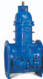
Séria 55 Prírubový posúvač DN 450-600 PN 10 alebo 16 S prispôsobivým osadením Plný vývrt, vymeniteľné tesnenia vretena, DN 80 obtok GJS-500-7
