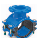
Séria 257 Univerzálna spona Supacollar Opravný systém DN 100-300 Plyn: PN 7 Voda: PN 16 GJS-400-15
