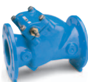
Séria 41/60 Spätná klapka mäkkotesniaca Voľný hriadeľ Pánt/disk DN 50-300 PN 10 alebo 16 GJS-500-7
