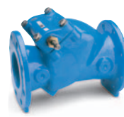
Séria 41 Spätná klapka mäkkotesniaca Vofný hriadeľ Pánt/disk DN 50-300 PN 10 alebo 16 GJS-500-7
