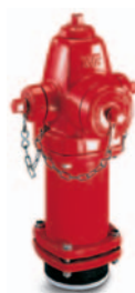
Séria 27 "Suchý" protipožiarny hydrant moderný štýl Hĺbka na zakopanie 2 1/2' - 10' 250 PSI, GJS-500-7 na zozname UL/ULC, schválené FM
