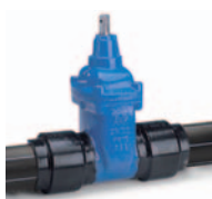
Séria 36 Posúvač s PE-koncami DN 65-300 PN 10 alebo 16 PE 100 GJS-500-7
