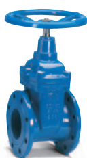
Séria 06 a 26 Prírubový posúvač DN 40-600 PN 10 alebo 16 GJS-500-7
