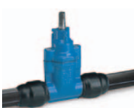
Séria 36 Servisná prípojka s PE-koncovkami DN 25-50 PN 10 GJS-500-7
