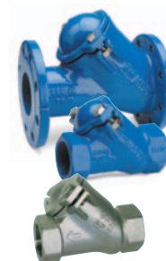
Séria 53 Guľová spätná klapka s vnútorným závitom DN 32-50 alebo s prírubovými koncami DN 50-400 PN 10 GJS-400-15
