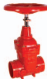
Séria 06/37 Posúvač s hrdlovými koncami s indikátorom polohy a ručným kolesom pre protipožiarnu ochranu PN 10 alebo 16 DN 50-300 GJS-500-7
