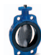
Séria 75 Uzatváracia klapka medzi prírubová DN 50-300 PN 10 alebo 16
