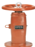
Séria 34/80 Nástenný stĺpový indikátor DN 100-300 P.I. pre posúvače Dĺžka vretena 250-1250 mm GJS-500-7 na zozname UL/ULC, schválené FM
