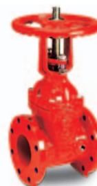
Séria 25 Prírubový posúvač s vyvýšeným vretenom DN 65-250: GJS-250 DN 300: GJS-500-7 200 PSI Na zozname UL/ULC, Schválený FM
