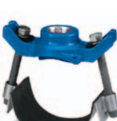
Séria 730/2 Univerzálne odbočkový navrtávaci pás Kujné železo / nerezová oceľ PN 16 / PSI 250 DN 80-300 Tesniaci rozsah 88-365 mm BSP 1/2"-3"
