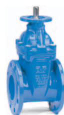
Séria 15 Posúvač pre ovládanie servopohonu DN 40-500 PN 10 alebo 16 GJS-500-7
