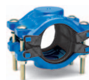
Séria 253 Univerzálna spona Supacollar Opravný systém DN 80-300 Plyn: PN 7 Voda: PN 16 GJS-400-15
