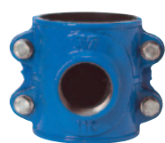
Séria 10 Navrtávaci pás pre PVC a PE-potrúbia DN 50-300 GJS-500-7 Spodná časť z nerezovej ocele DN 250
