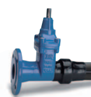
Séria 38 Posúvač - jeden koniec s PE-koncom, druhý koniec s prírubou DN 50-200 PN 10 alebo 16 PE 100, GJS-500-7
