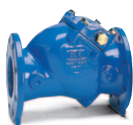
Séria 41/61 Spätná klapka tanierová pánt/disk alebo disk z pevnej gummy DN 50-200 PN 10 alebo 16 GJS-500-7
