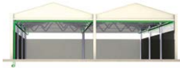
Podtlakový systém odvodnění
