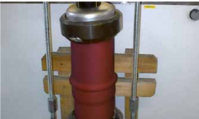
Zkouška těsnosti 2,5 baru
